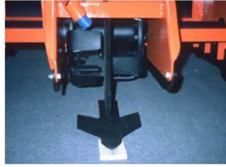
**Dent de chisel et fraise**
