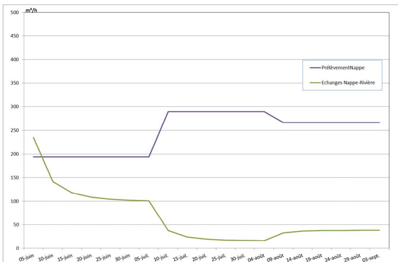
Figure 31 représente la variation des débits d'échange entre nappe et rivière en fonction des variations de prélèvements. On note que 5 jours après la mise en route d'un prélèvement, Les deux tiers du débit prélevé en nappe sont soustraits au débit de la rivière. Cette proportion atteint 80 % au bout de 10 jours et 85 % au bout de 15 jours. Cette incidence rapide et forte des prélèvements en nappe sur la rivière est due à la forte transmissivité, entraînant une grande étendue des cônes de rabattement, et un débit d'échange important même en cas de faible variation de charge. De plus, la rivière n'est jamais bien loin.
