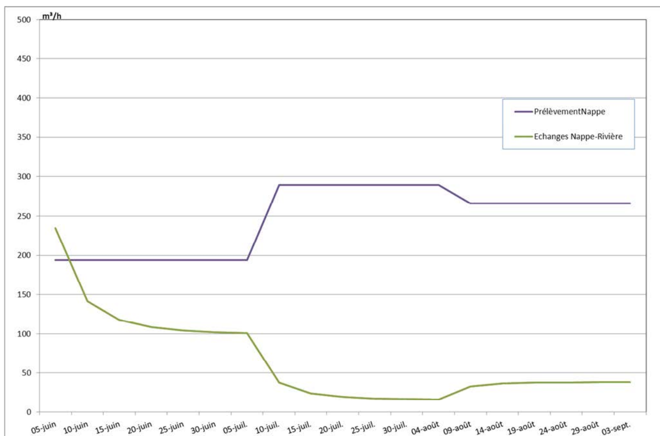
Figure 31 : Evolution des échanges nappe-rivière en fonction des prélèvements en nappe
