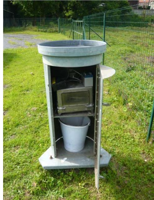
**Figure 6 : Pluviomètre de Saint Léger**
