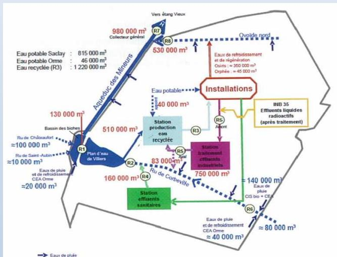
Figure 17 : Le cycle de l'eau au CEA et les volumes d'eau observés en 2010
