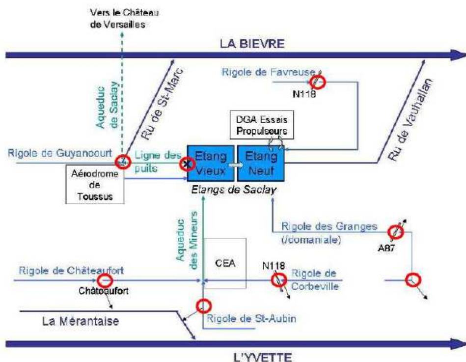
Schéma du fonctionnement du réseau hydrographique du plateau (Source EPPS – SOGREAH : Etude globale de gestion des eaux du plateau de Saclay – 2010)
