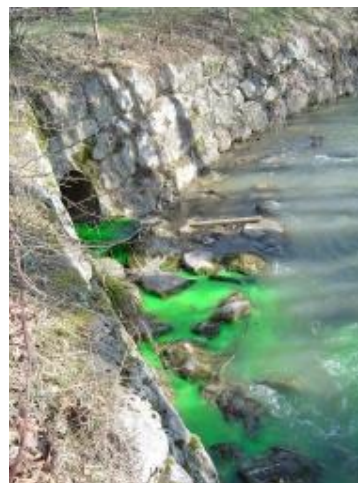
Photo 27 : Opération de traçage à la fluorescéine sur réseaux d'eaux pluviales (source : SIFOR)
