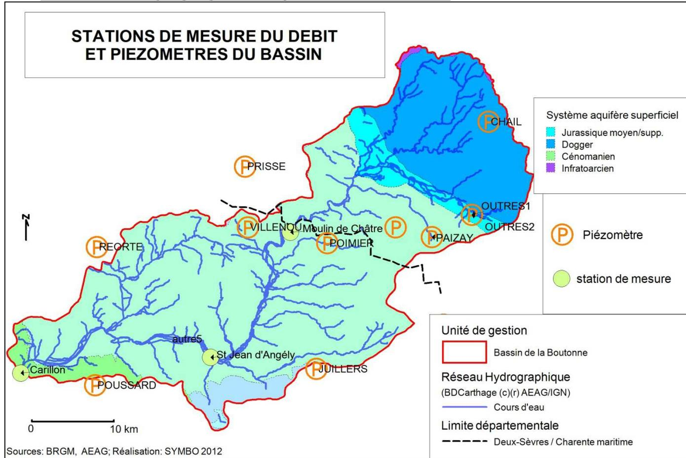
**Aquifères du bassin de la Boutonne, position des piézomètres et des stations hydrologiques, limites des zones de gestion proposées**
