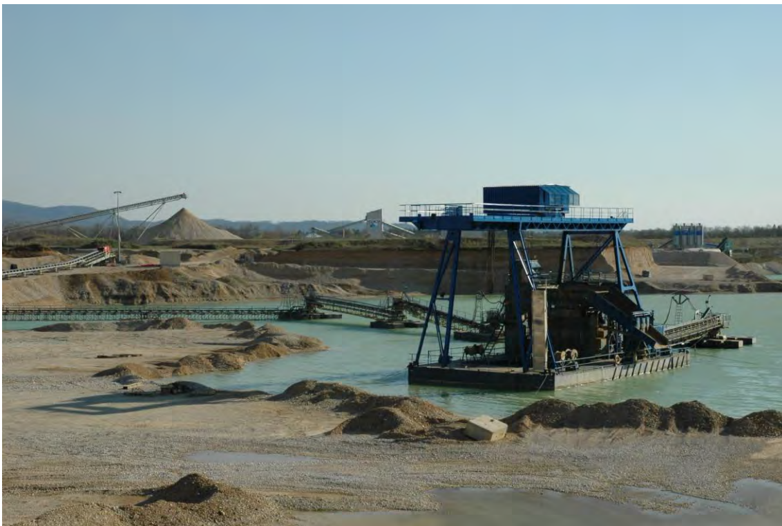
Extraction de granulats en milieu alluvionnaire(01): on observe l'affleurement de la nappe alluviale (© L. Cadilhac). La présence de gravières peut modifier les écoulements souterrains et influencer sur les échanges nappes/rivières.
