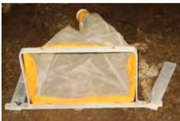
Illustration 17 : Filet à dérive utilisé dans les sources (© P. Marmonier)
