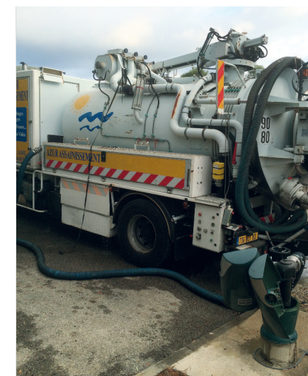
Usage autorisé mais non réglementé : camion hydrocureur s'alimentant en eau traitée sur borne de puisage (de l'ordre de 500 m 3 d'eau réutilisée par an) qualité A
